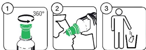
1. Ruotare il tappo verde della stazione di lavaggio oculare di 360°.
